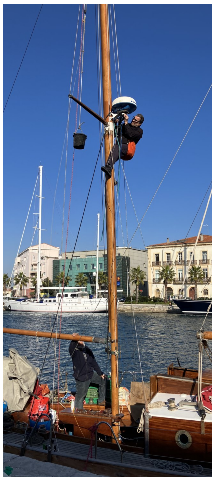
Démontage du radar
