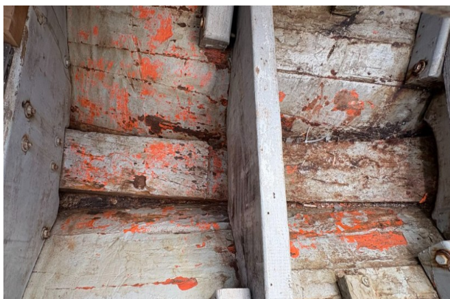
Les pièces de bois abîmées ont été réparées ou remplacées, la peinture entièrement refaite
